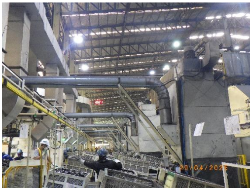
รูปที่ 2-12 เครื่องดูดอากาศแบบเคลื่อนที่ บริเวณการเจียรแต่ง
